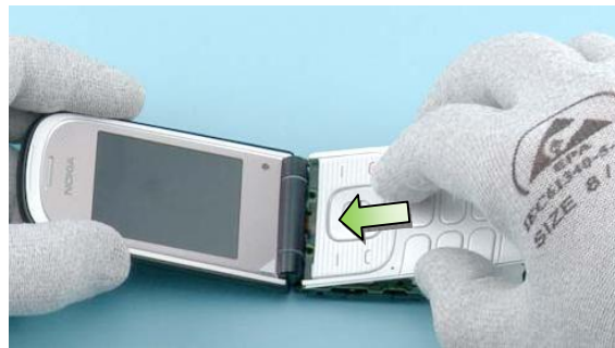
42) Attach the KEYPAD.
